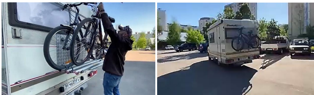
Рис. 1. – Автофургон с оборудованным местом для перевозки велосипедов
